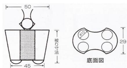
※特殊なダブルチャックを使用しており、コンクリート打設時や締固め時でのスペーサーの脱落がありません。
